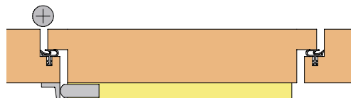
flächenbündig: aufgeschraubt auf der Schließfläche
